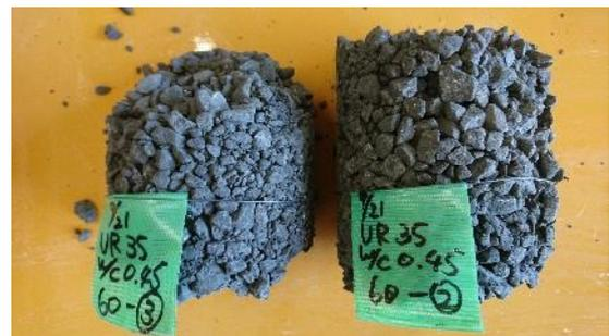
写真-1 骨材の剥落が生じた POC (VR = 35%, 攪拌時間 60 分)
