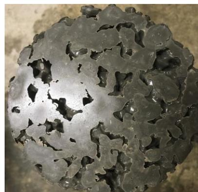
写真-2 試験体底面のペーストだれの状況 (HAE/C=0.4%, 経過時間 0 分)
