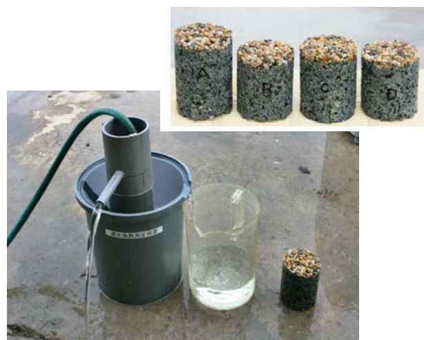
写真 7 JCI 規準(案)によるコア供試体の透水係数測定
