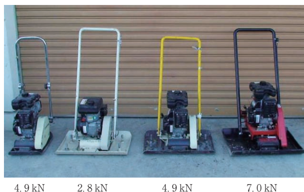
写真-3 表面振動機（左：市販の振動コンパクタ、右 3 機：仕上げ機、写真下の数値は起振力）
