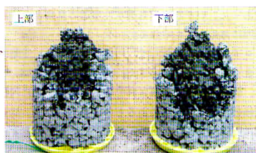
写真-9 圧縮試験を行った円柱供試体の破壊状況
