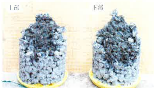
写真-9 圧縮試験を行った円柱供試体の破壊状況
